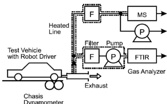
上図のようにシャシ・ダイナモーメータとサンプリング系を構成したIMR-MSとFT-IRによる排ガス測定において、右図はベンゼンに対するIMR-MSとFT-IRの測定値の重ねです。両回答に相関がみられないのは、FT-IRではベンゼンのような重い炭化水素の測定が不向きで、サンプル中のほかの高濃度の炭化水素の存在に相互作用を受けてしまうためです。IMR-MSでは、そうした妨害成分の影響を除去することができます。
