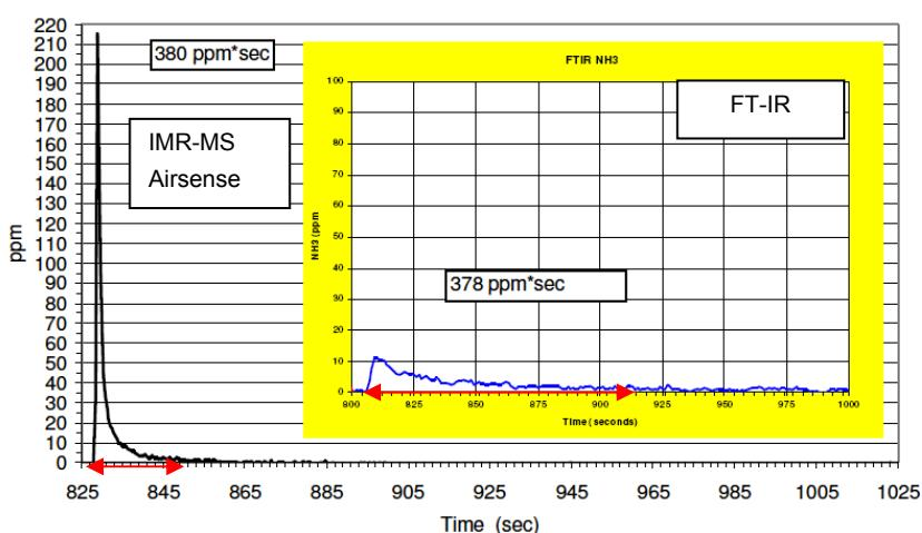
左図は、アンモニアリリースの計測における応答速度を、IMR-MS(白枠)とFT-IR(黄枠)で比較したもので、両方とも積分値としては、378~380ppmとほぼ等しいのですが、応答速度に大きな違いが認められます。FT-IRでは、800秒から915秒までの115秒間にわたって積算されており、ピーカらしいピークは見られておりません。一方、IMR-MSのグラフでは、ほんの20秒以下で顕著な応答ピークが示されております。積分値として値を判断すれば、両技術とも同じと見なされますが、応答速度T90については、FT-IRで約3sec、IMR-MSでは50msecと大きな性能面の違いが見られます。
