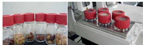
図 2: ナッツの分析に使用した大容量バイアルと温度管理可能なペルケム式トレイ
